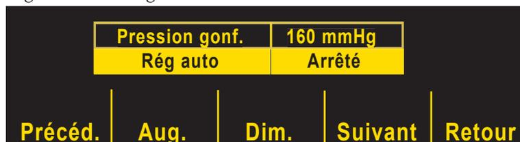
4. Appuyer sur la touche de fonction **Retour** (deux fois sur les appareils CCT M Series) pour revenir au menu PNI. L'appareil M Series reprend la même pression de gonflage du brassard à chaque mesure.
